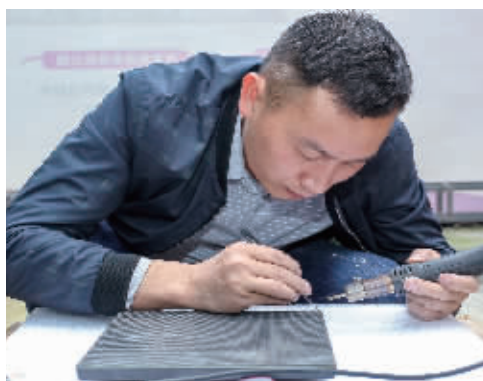
安装小间距LED屏过程中,屏幕偶尔会被磕碰掉部分微晶元件,陈明俊正在使用风枪和锡膏焊锡修复LED屏幕,让发生故障的LED屏“起死回生”。
