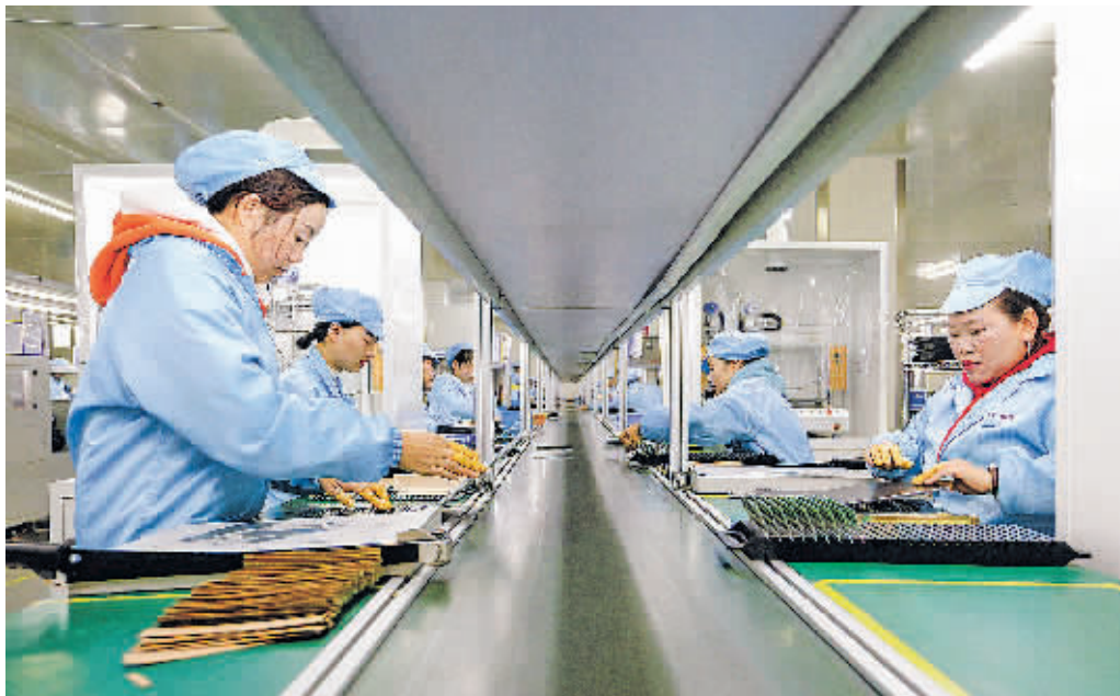
图为贵州全安密灵科技有限公司工人在生产电子雷管模块。
