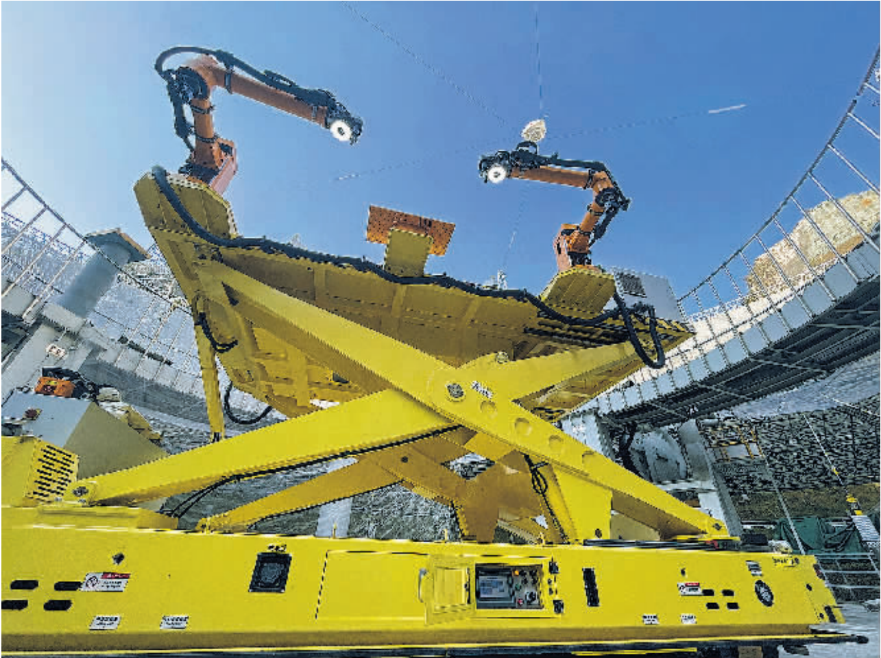
FAST馈源接收机拆装机器人。 贵州航天控制技术有限公司 / 供图
