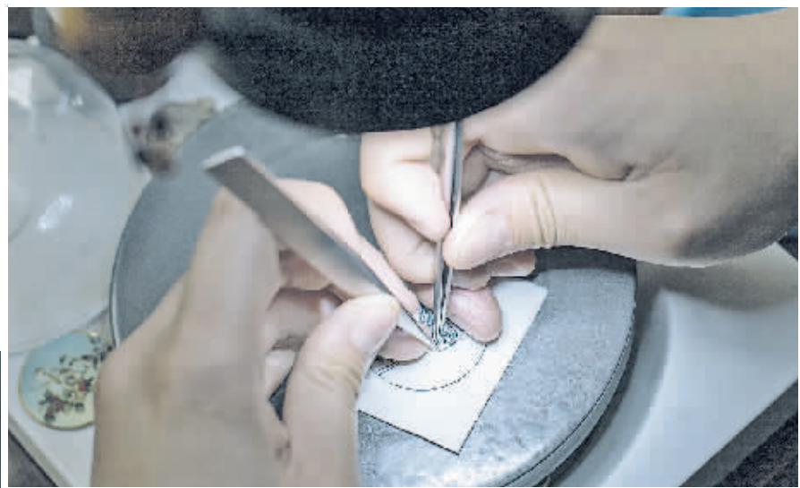
技师在用景泰蓝显微掐丝工艺制作手表盘。
