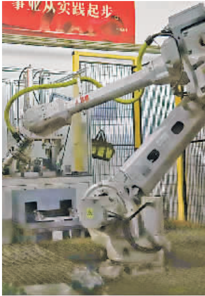
贵阳万江航空机电有限公司减壳体加工单元机械手正在工作。
