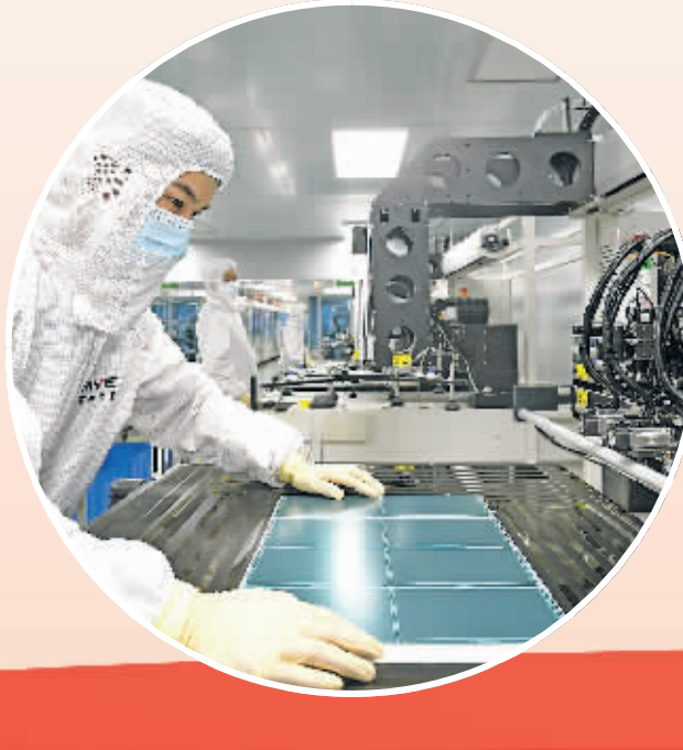
南明智能制造产业园内，联积电子（贵州）有限公司技术人员在进行切割作业。
