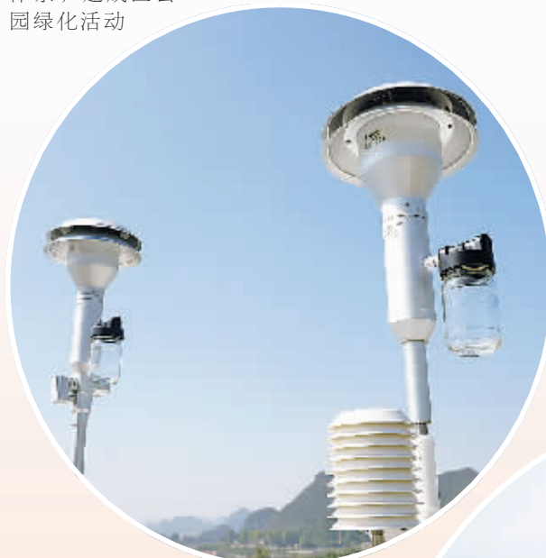
清镇市在红枫湖畔建立的空气质量连续自动监测系统。 通讯员 代胜强 摄
