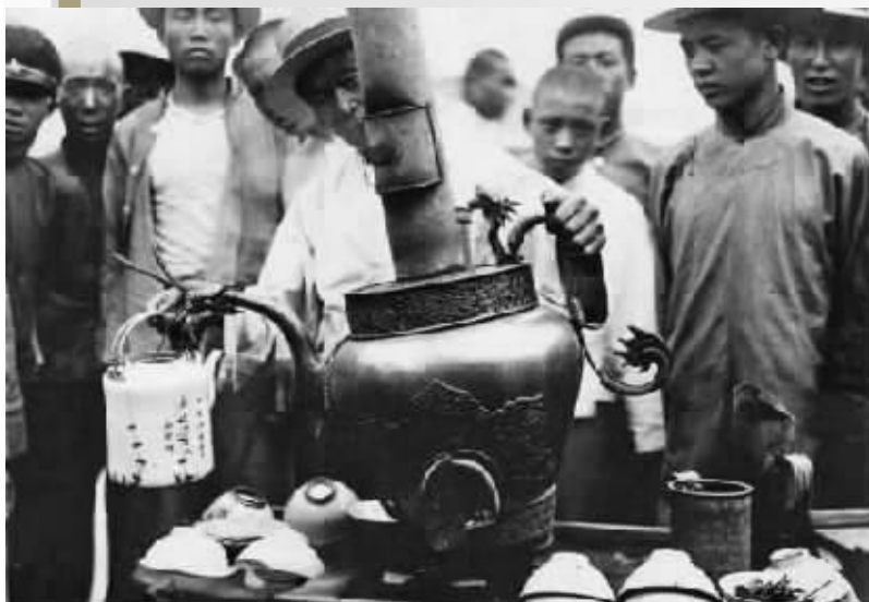
大茶馆用的大铜壶,壶底有夹层,夹层可以放入烧红的炭块,壶内有一条直上直下的烟道,方便炭的燃烧和取放。
