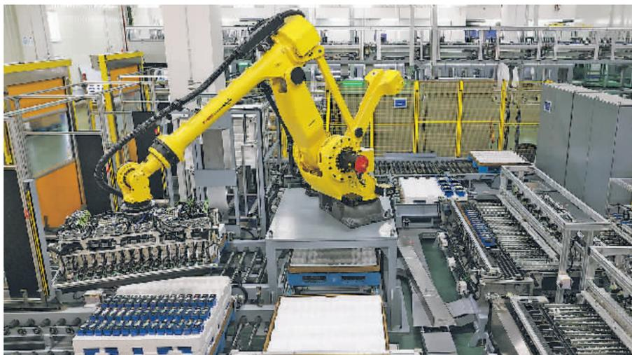
在宁德时代贵州基地容量厂房里,机器臂正在码放电芯。 贵阳日报融媒体中心记者 石照昌 摄
