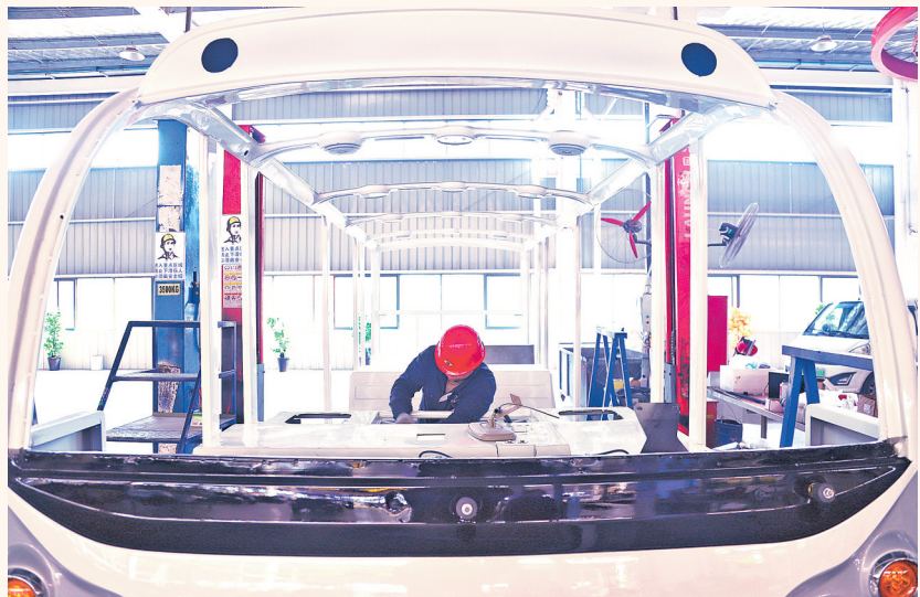
在忠辉重工生产车间，工人在组装车身骨架。
