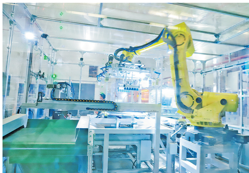
在贵阳海信车间，机器人正在抓取电视机背板。
