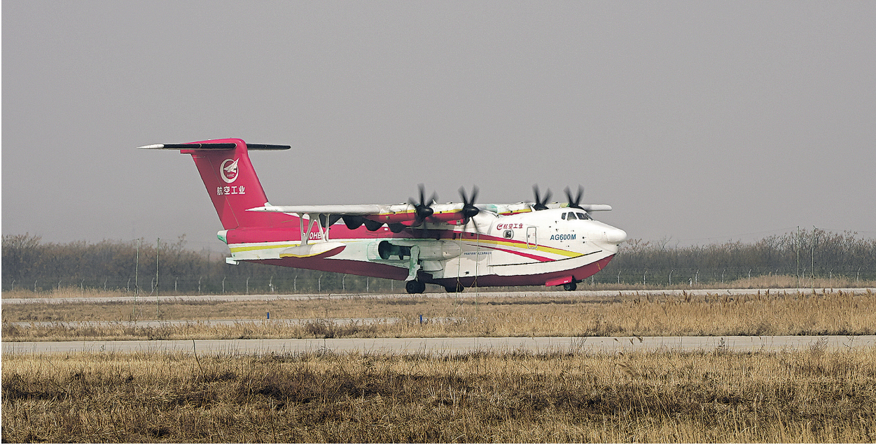
2月28日,大型水陆两栖飞机AG600“鲲龙”在陕西蒲城完成可燃液体排放表明符合性试飞。 新华/传真
