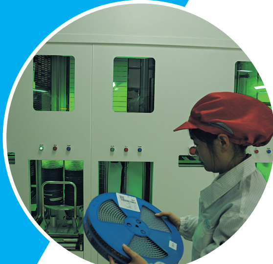
▲在贵阳海信智能料仓,工作人员准备将一盘电视机芯片放入智能料仓,由智能料仓自动识别、筛选和入库、出库。
