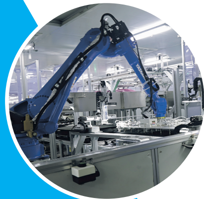
▲在贵阳海信智能制造车间,机械臂正在组装电视机。
