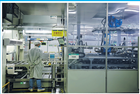
▲在贵阳海信智能制造车间,机器人正在对电视机面板进行卡合。
