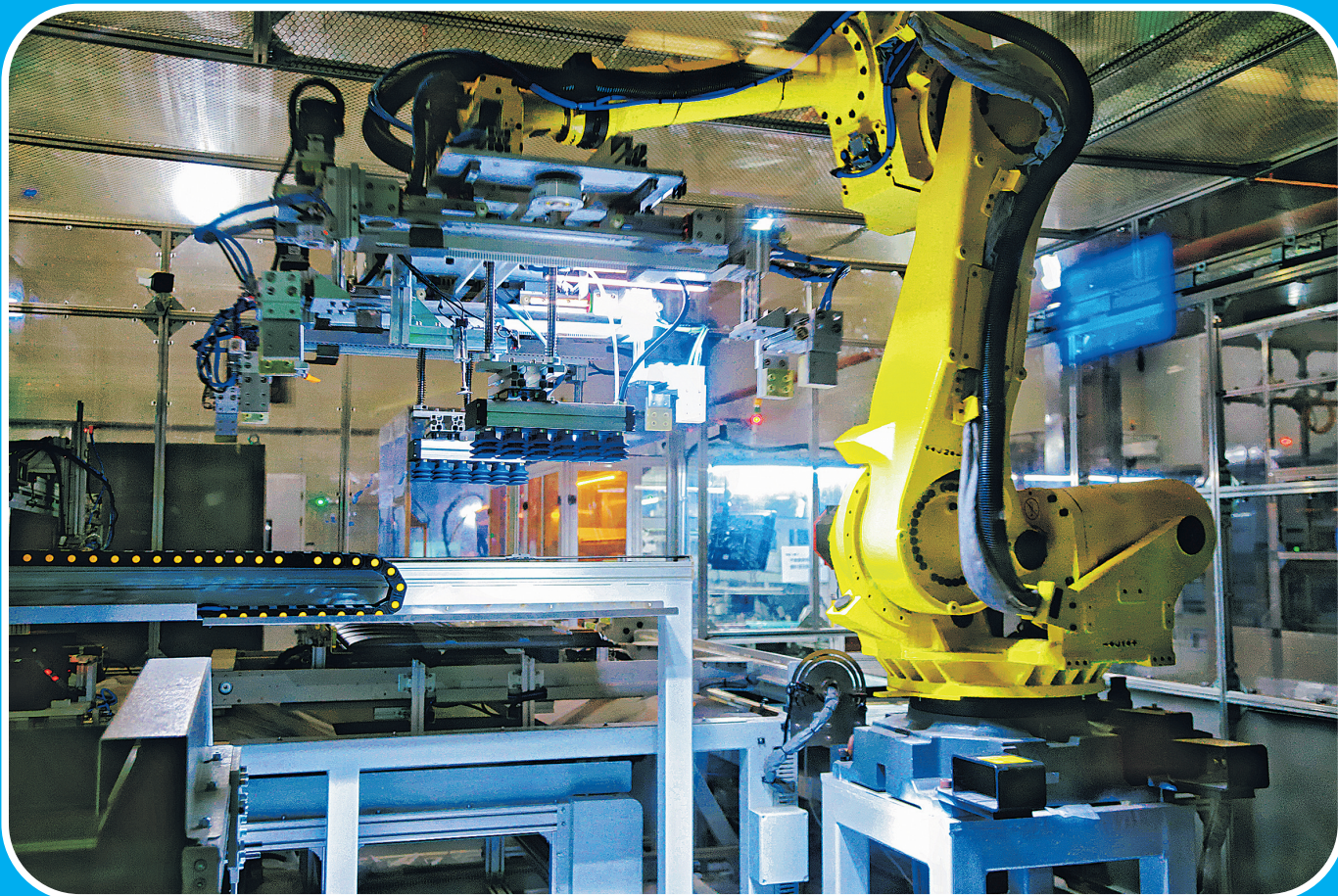
▲在贵阳海信智能制造车间,机器人正将电视机背板放上产线。
