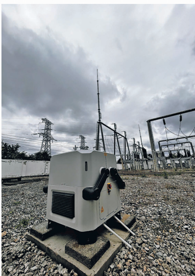
贵安供电局投用的首个无人机机巢。
