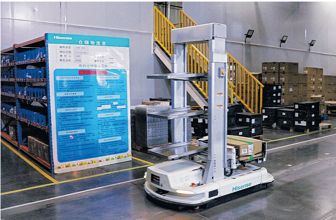
料箱式机器人将物料从立体仓库送往电视机生产车间。
