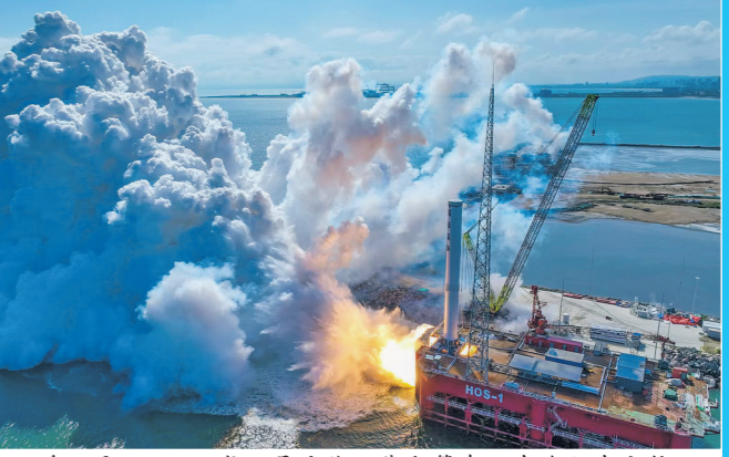
2025年9月15日,天龙三号液体运载火箭在山东海阳东方航天港海上平台进行一级动力系统试车(无人机照片)。
