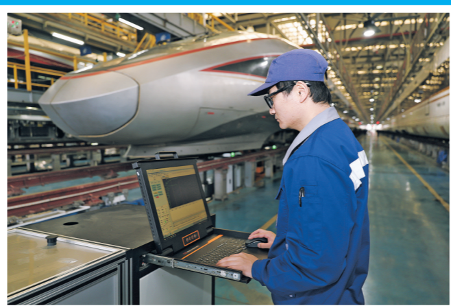
在上海动车段虹桥动车运用所,地勤机械师运用智能化钢轨超声波探伤机对动车组车轮进行超声波探伤(2026年2月28日摄)。
