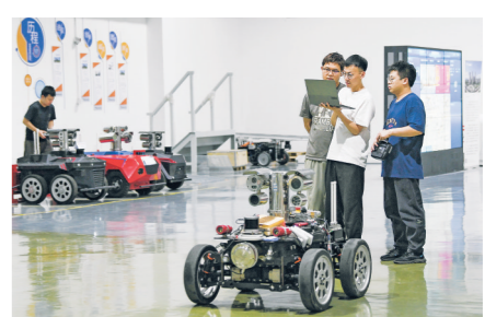
在位于重庆两江新区的七腾机器人有限公司重庆工厂,技术人员在调试防爆轮式机器人(2025年5月27日摄)。
