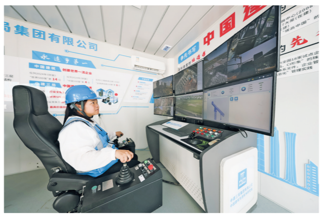
中建三局华东公司塔机操作人员在5G塔机集控驾驶舱内远程操控塔吊(2025年5月1日摄)。
