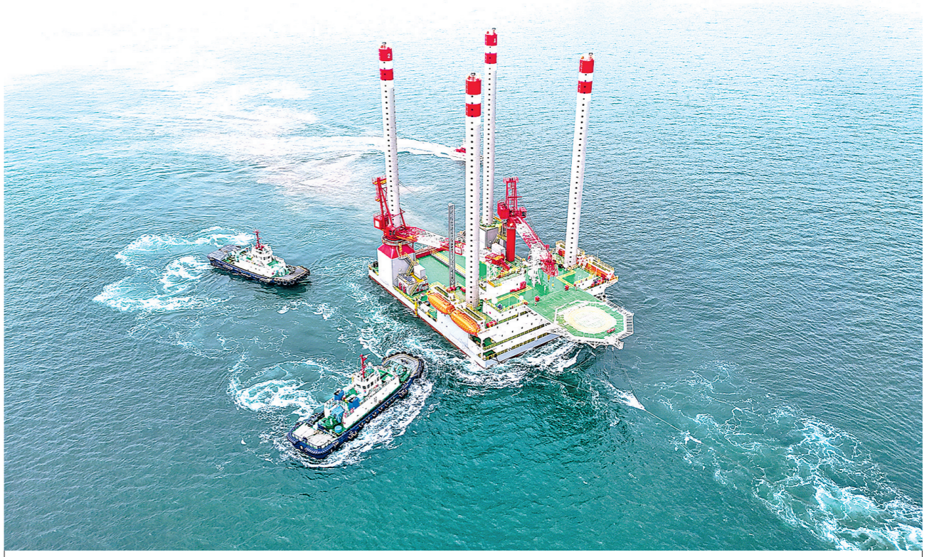
5月14日,我国首座海上移动式多功能措施平台“海洋石油283”(又称“增产一号”)从青岛西海岸新区启运,发往渤海油田。该平台采用“移动式+模块化”设计,总重7300余吨,最大作业水深40米,集酸化、压裂、调驱、调剖、稠油热采等功能于一体,并引入AI智能监测,投用后将有效支撑渤海油田增储上产。图为当日,我国首座海上移动式多功能措施平台“海洋石油283”从青岛西海岸新区启运(无人照照片)。 新华/传真
