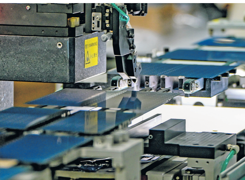
在新疆巴音郭楞蒙古自治州若羌县一家新能源有限公司,全自动划片机在切割光伏电池片(2025年9月22日摄)。
