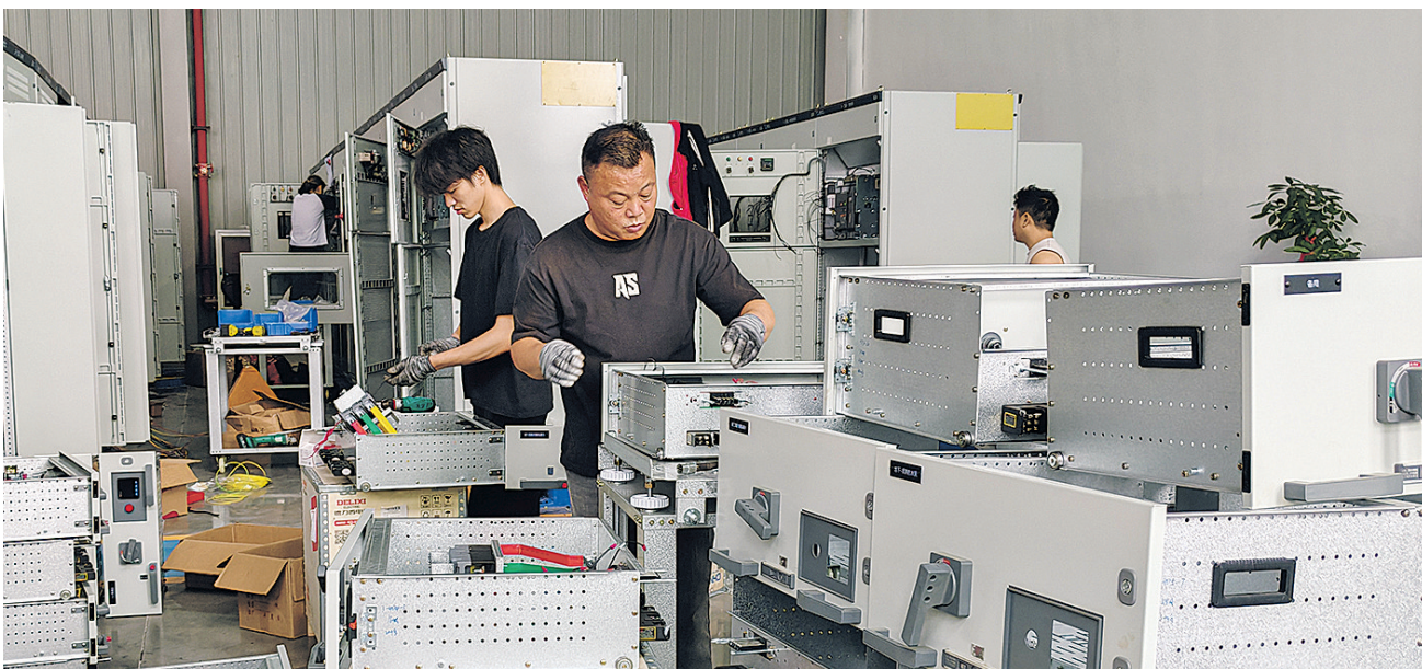
贵州浙黔电气设备有限公司技术人员在装配高低压配电柜。
