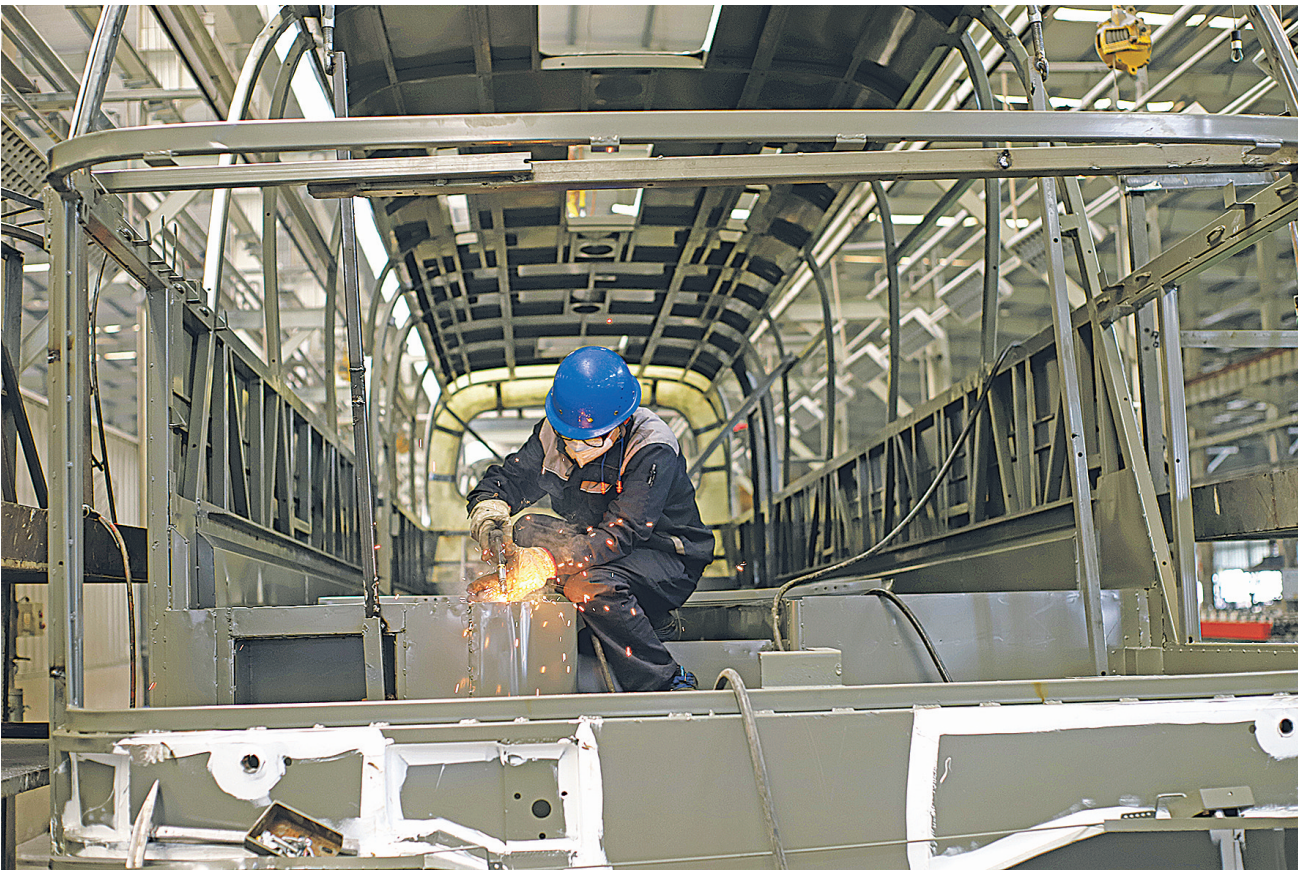
奇瑞万达贵州客车股份有限公司焊装车间里,工人正在焊接客车“骨架”。
