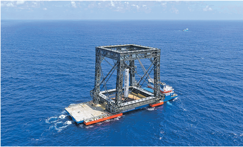
图为海上回收平台通过网系捕获方式成功回收长征十号乙运载火箭一级级(7月10日报,无人机照片)。
